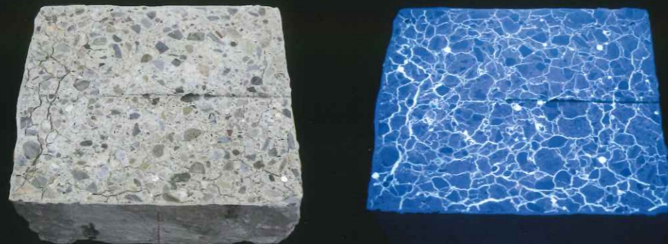
※ブラックライト照射による樹脂の充填状況
